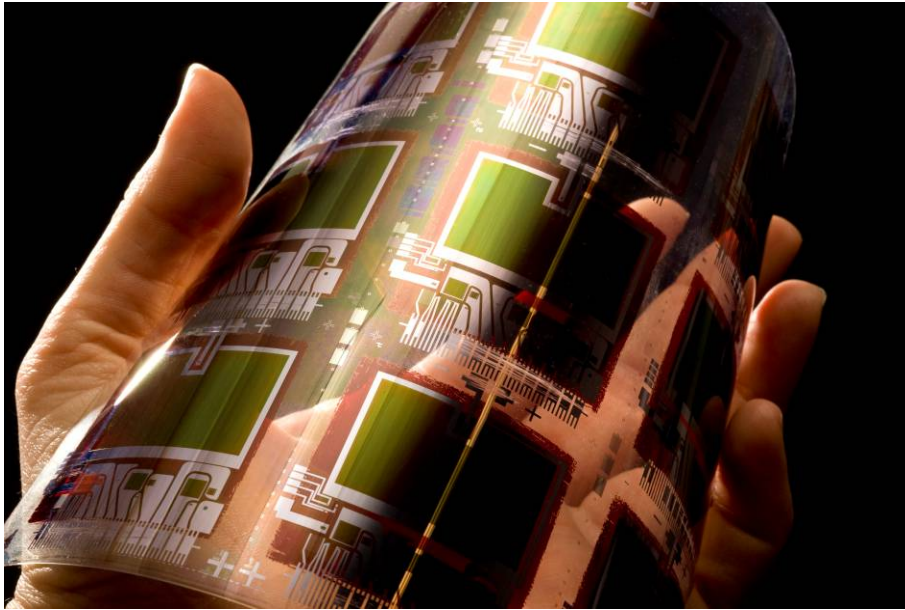
Bild: Flexibel, leicht und robust: Organische und gedruckte Elektronik ermöglicht neue Anwendungen. Beispiel einer gedruckten Solarzelle (Foto: Holst Centre, Niederlande).
